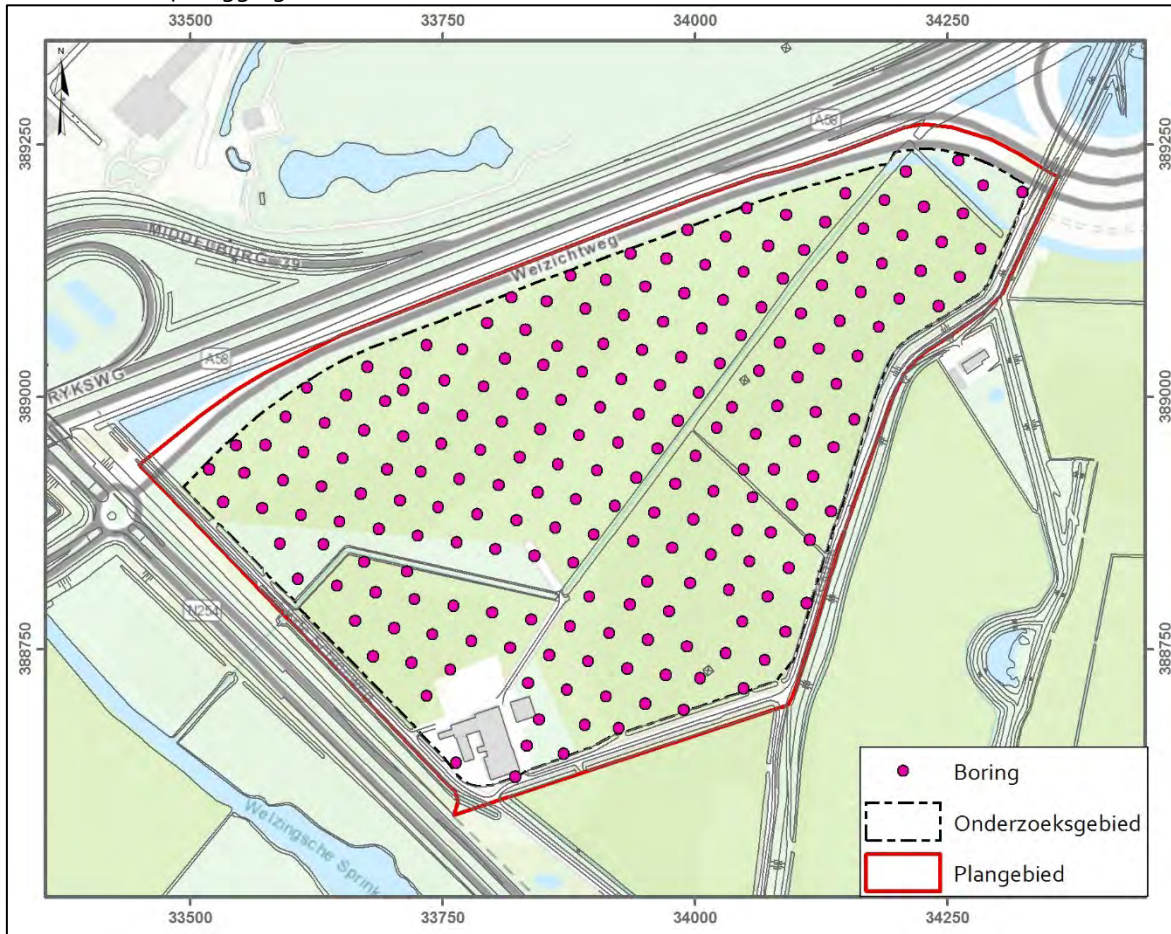
Abbeelding 32 Overzicht van de uitgevoerde verkennende boringen. Schaal 1:7.500. Bijlage 2 geeft een meer gedetailleerd beeld met daarop de boornummers en de Bodemkundige Overzichtskaart van Walcheren als ondergrond. Bron ondergrond: Esri/Kadaster, 2018.
